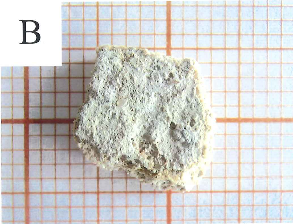
Fot. 2. Próbką B – tynk w blendzie pokryty zacierką, miejsce pobrania: pierwsza od zachodu blenda na elewacji południowej korpusu nawowego.
